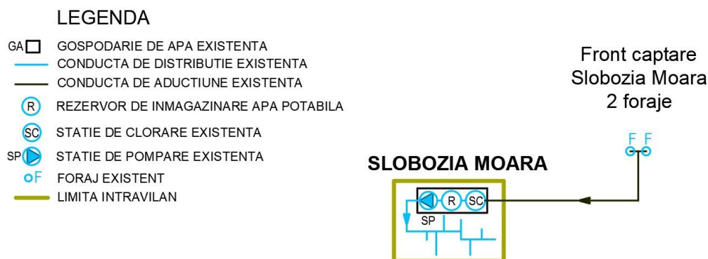
Figura 4-17 Schema sistemului de alimentare cu apă în Slobozia Moara
